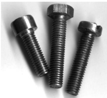
Gleiches Gewinde, anderer Kopf (v.l.n.r.) Innensechskant, Außensechskant, Schlitz
