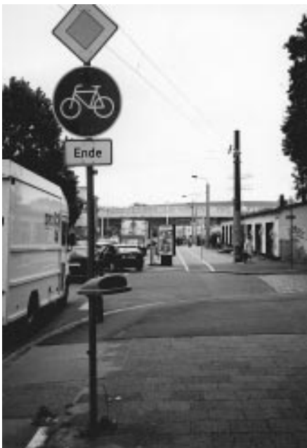
Radweg auf der Kesselsdorfer Str. – Radfahren im toten Winkel der Rechtsabbieger, schlechte Sicht durch Werbeschild, schlechte Oberfläche
