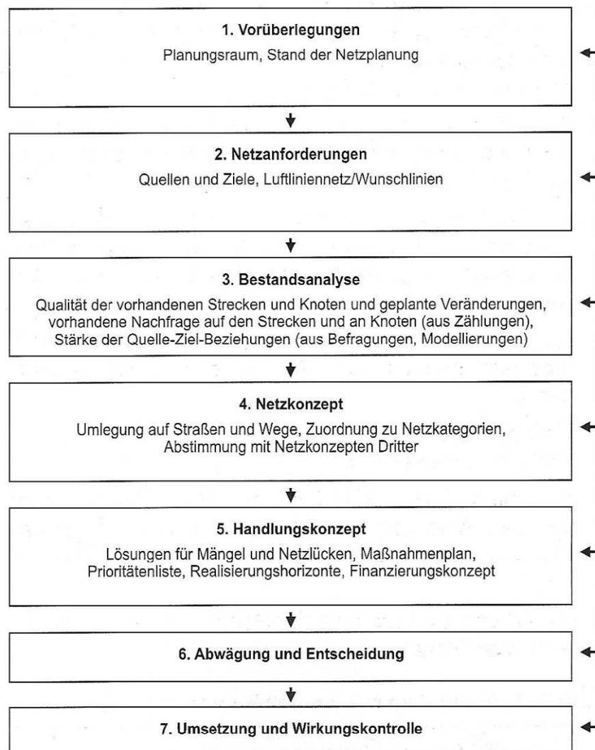
Abbildung 2.6: Ablauf einer Radverkehrsplanung für den zielorientierten Alltagsradverkehr
