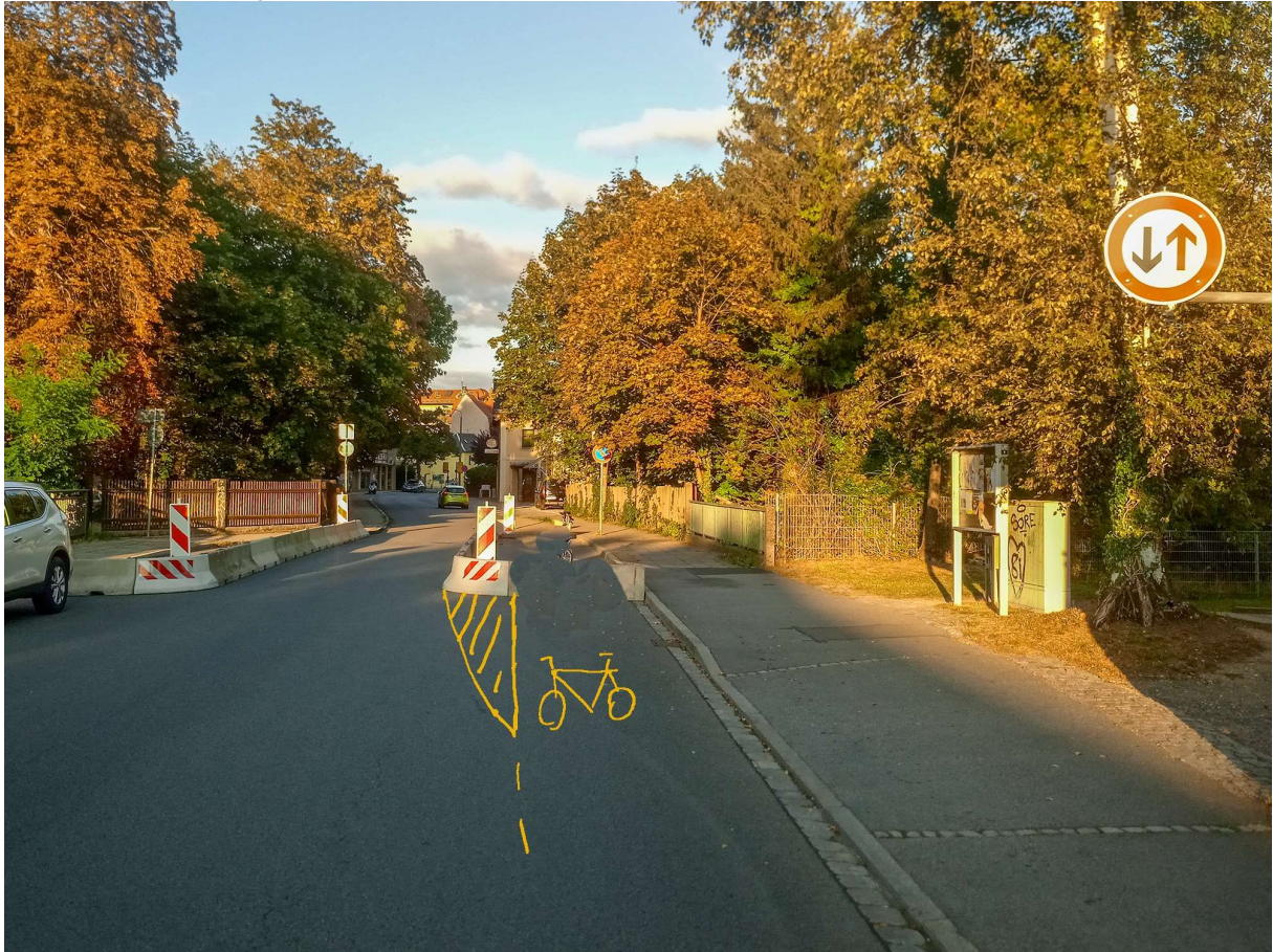
Skizze der vorgeschlagenen „Radschleuse“
