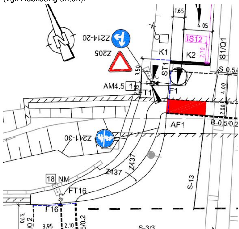
Abbildung: Ausschnitt aus dem ABM-Plan (Unterlage 16_05_03 der Planfeststellung Zentralhaltestelle) bzgl. der Führung des Radverkehrs von Nord nach Süd am Knoten Coventrystraße.
